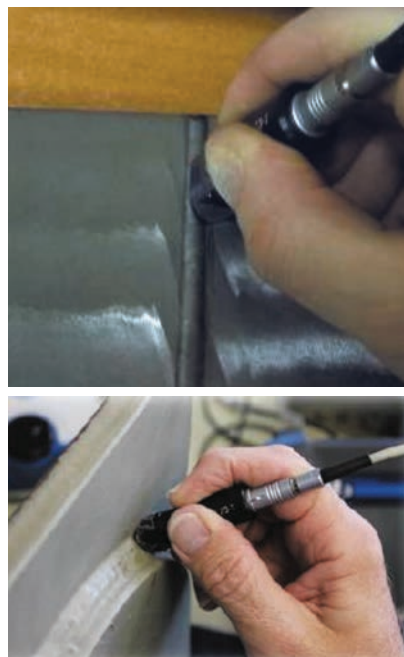
Рис. 1. Вихретоковый контроль сварных соединений
