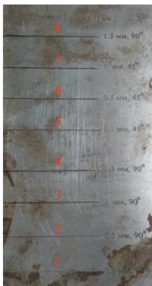
Рис. 15. Образец из стали 20 с рисками
