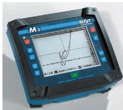
Рис. 2. Внешний вид вихретокового дефектоскопа Elotest M3
