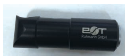
Рис. 3. Специализированный датчик для сварных соединений
